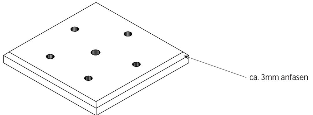
3. Eine Sperrholzplatte 4 x 80 x 80 mm ausgemittelt unter den Deckel leimen (s.Seite 3).
